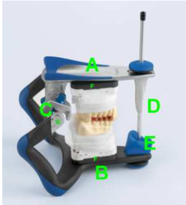
Fig. 2 – Schema tipo di un articolatore (nella foto un modello della serie Artex Carbon)
